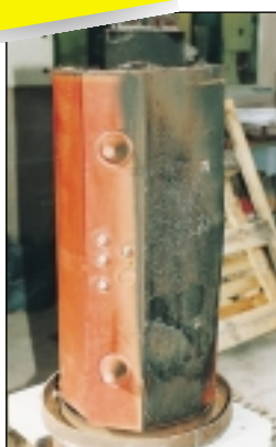
Катушка трансформатора Trihal после испытания F1
